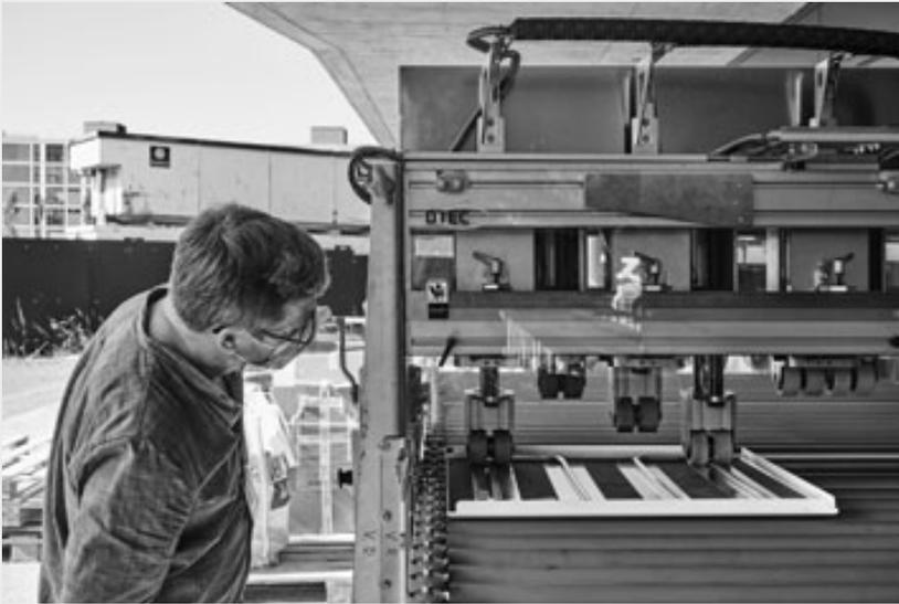
*Die Akustikdecke der Unit wurde zu einer Heiz- und Kühldecke aufgerüstet. Dabei wurden die Kupferleitungen mit einer eigens dafür entwickelten, mobilen Maschine auf die Akustikelemente gepresst.*
